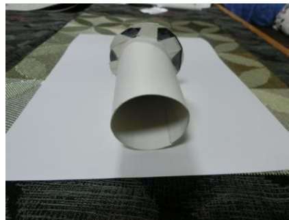
下からみたホルダーー 太陽光シートを天板と 筒でサンドイッチ
